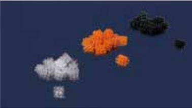
Der statische Einwegmischer GXP aus PP oder PA66 mit 50% Glasfaser hat einen Durchmesser und eine Länge von jeweils 9,4 mm. Er wird, wie der statische Einwegmischer GXF, für schwierige Mischaufgaben bei kleineren Durchsätzen verwendet. Standardrohre sind erhältlich mit 20 eingesetzten Mischelementen. Für Anwendungen unter hohem Druck sind spezielle Mischrohre erhältlich, deren max. Betriebsdruck bei 100 bar liegt.
