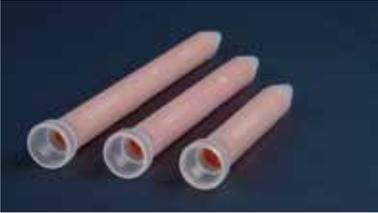
Der GXF-10-Einwegmischer ist ein faltbarer Einwegmischer mit einem Innendurchmesser von 10 mm in Standardrohren mit 6, 9 oder 12 Mischelementen. Mischelemente sind auch lose für den Einbau in entsprechenden Stahlrohre mit Innendurchmesser von 12 mm verfügbar. Dieser X-Gitter-Mischertyp eignet sich optimal für schwierig zu mischende Harz/Härter-Systeme, wie z. B. 2-K-Lacke, PU, Kleb- und Dichtstoffe sowie für Medien mit grossen Viskositätsunterschieden.
