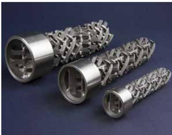
SMB-GXS als gegossene Einheit mit integrierten Verstärkungsstangen (mittig & rechts) im Vergleich mit geschweisstem SMB-GX Schmelzemischer (links).
